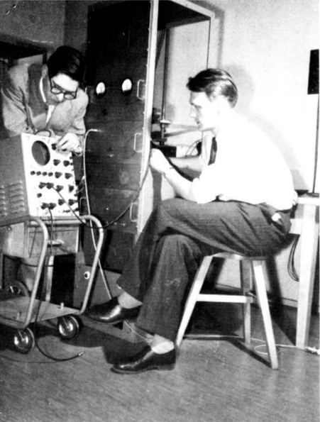
40 watin kuvalähetin tutkittavana. Lähetintä virittämässä Erkki Larkka, tarkkaajana Martti Tiuri. (Lehtikuva)
