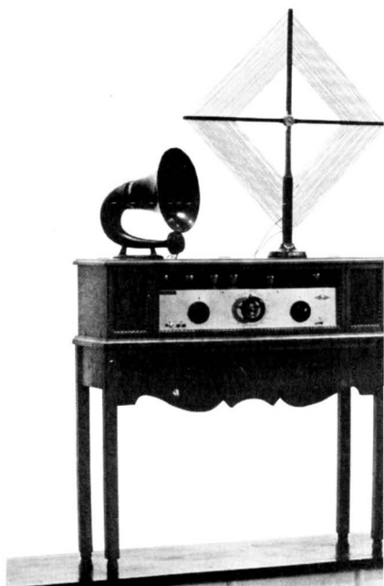
Radioeleganssia 1920-luvulla: 6-putkinen neutrodyne, torvikaiutin ja kehäantenni.
